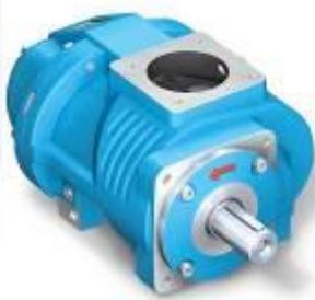
**Винтовой блок EVO6** производится компанией Rotorcomp (Германия) и является основой винтового компрессора. Визуально он представляет собой чугунный корпус, внутри которого, на подшипниках размещены два ротора, сжимающие воздух.
