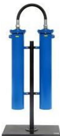
Фильтрационный модуль предназначен для тонкой очистки сжатого воздуха и различных газов, от аэрозолей масла и влаги, а также от твердых частиц размером более 10 мкм. Обеспечиваемое остаточное содержание аэрозоля масла - менее 16 мг/м<sup>3</sup>. Используется в системах пневмоуправления и автоматике, пневмоприводе устройств и инструмента для окраски поверхностей распылением.
